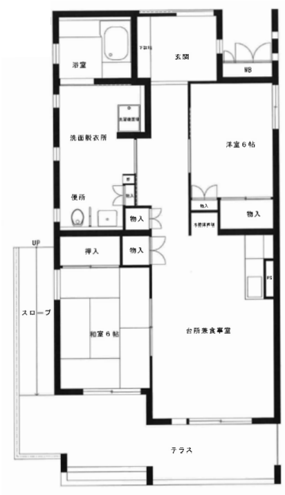
⑰ 深沢四丁目アパート 4号棟104号室 (車いす世帯向け)
